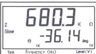
Die Wahl von Messpegel und Messfrequenz erfolgt mit den entsprechenden Tasten **Level** bzw. **Frequency**.
