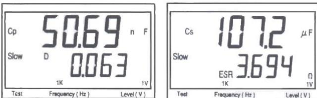
Die Wahl von Messpegel und Messfrequenz erfolgt mit den entsprechenden Tasten **Level** bzw. **Frequency**.
