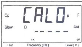
Der Kalibriervorgang dauert ca. 10 Sekunden. Ein akustisches Signal ertönt nach erfolgter Kalibrierung.
