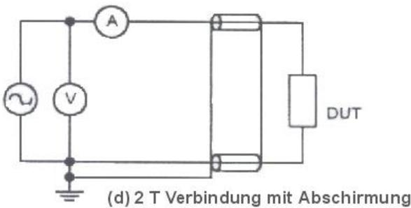
(d) 2 T Verbindung mit Abschirmung
